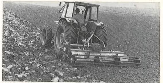
Abb. 7: Bei der Bearbeitung von feuchteren Böden ist eine grossdimensionierte offene Krümmerwalze vorteilhaft (Krone).
