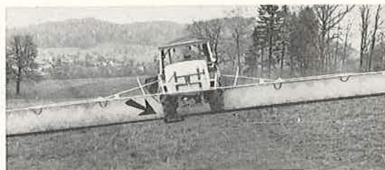
Abb. 2: Beim Spritzen am Hang in der Schichtlinie verflachen sich die Traktorreifen infolge Schwerpunktverschiebung. Dank der Hanganpassungsvorrichtung kann das Spritzgestänge parallel zur Bodenfläche eingestellt werden (Birchmeier).
