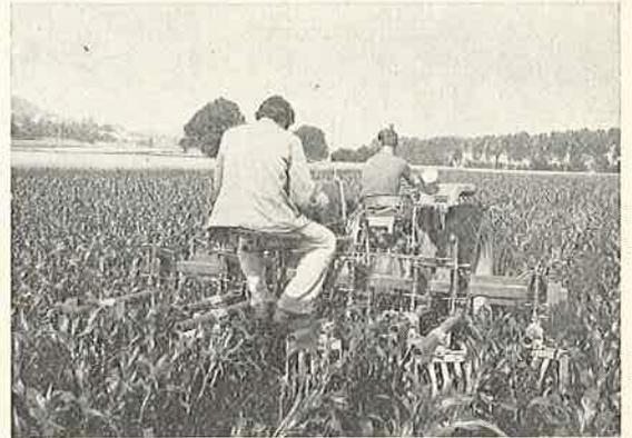
Abb. 3b): Hacksterne mit einstellbarem Federdruck und Gelenkführung.
