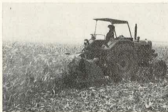
Abb. 10: Maisstrohzerkleinerer bei der Arbeit.
