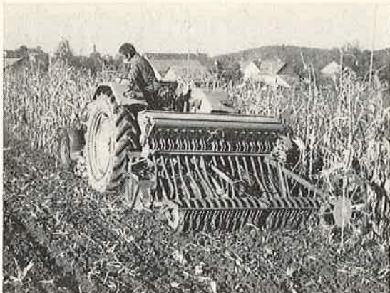
Abb. 2: Einsatz des Fräs-Drillverfahrens nach Mais. In einem Arbeitsgang wird das Feld fertig bestellt.
