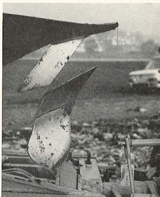
Abb. 8: An der Pflugschar befestigtes Kurzsech.
