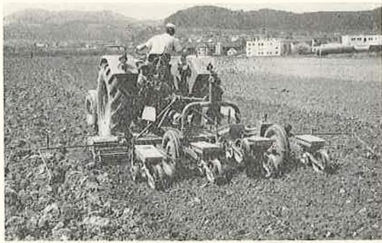
Abb. 6: Mais-Bestellsaat: Kreiselegge mit Einzelkornsämaschine.
