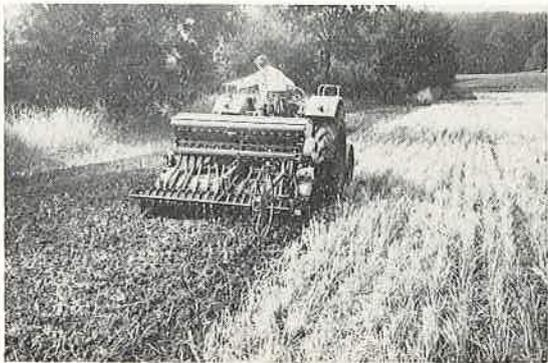
Abb. 3: Direktsaat mit Frässämaschine für Zwischenfrucht.
