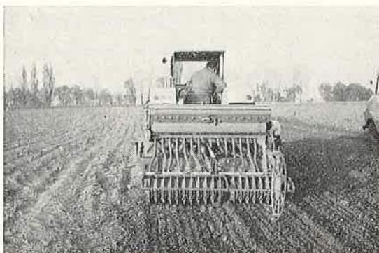
Abb. 1: Frässämaschine mit geschlossener Scheibenwalze, die auch zur Einstellung der Arbeitstiefe dient.
