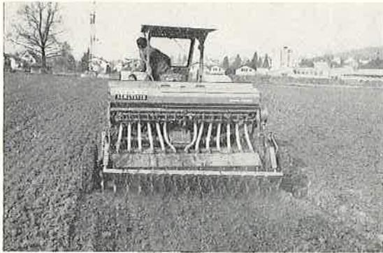
Abb. 2: Frässämaschine mit offener Scheibenwalze (Krümenpacker). Die Einstellung der Arbeitstiefe erfolgt hier durch Stützräder.
