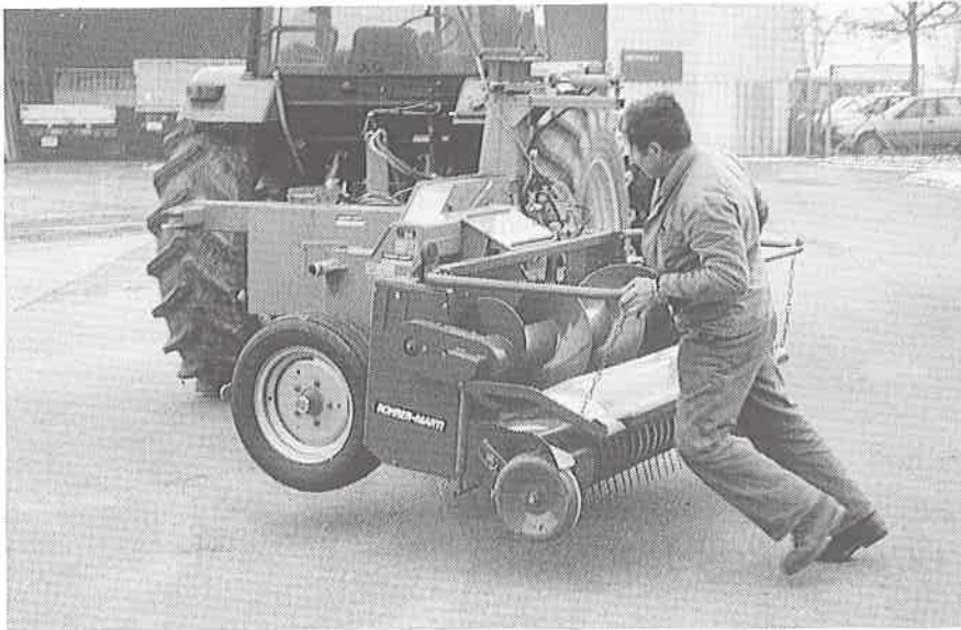
Fig. 1: Le changement de position de la hacheuse exige de l'habitude et un certain savoir-faire de la part du conducteur du tracteur. La manœuvre doit absolument se dérouler dans l'ordre correct.
