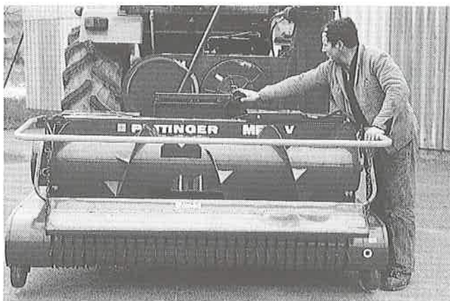
Fig. 7: L'aiguisage des couteaux et le réajustement de l'organe hacheur sont plus faciles sur la hacheuse à disque (à gauche) qu'avec le tambour (à droite).
