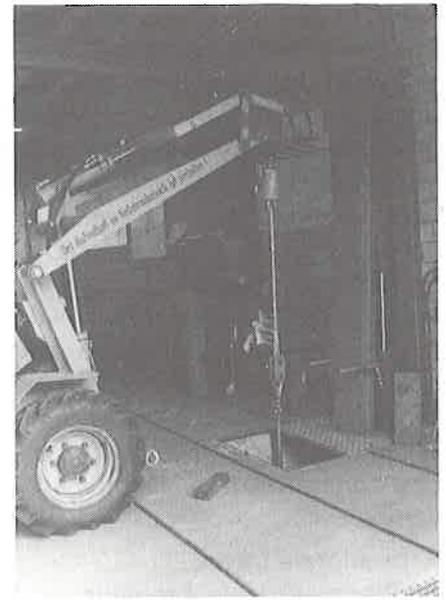
Fig. 14: Mesurage de la force de levage sur tout le rayon de levage des outils.
