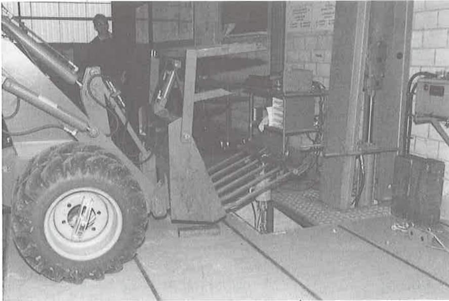
Fig. 13: Mesurage de la force d'arrachage à 10 cm à l'arrière des pointes des dents.
