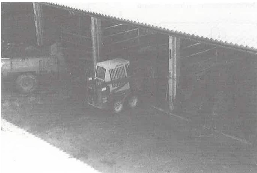
Fig. 4: Chargeur compact utilisé pour sortir le fumier d'une étable à stabulation libre. La manœuvrabilité des chargeurs automoteurs et des chargeurs compacts permet d'obtenir des capacités de chargement pareilles à celles d'un tracteur moyen avec un chargeur frontal.
