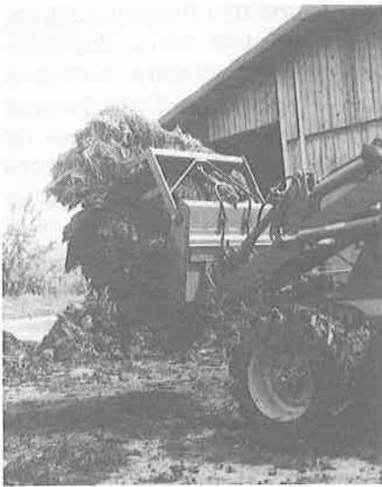
Fig. 7: La contre-griffe de la fourche à fumier (fourche croco) permet de bien la remplir et maintient le fumier fermement jusqu'à l'épandeur.
