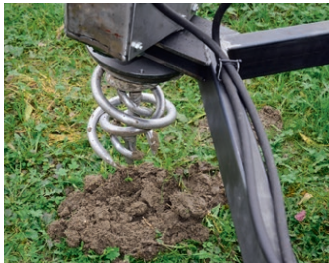
Abb. 5: Der Blackenzwirbel der Firma Odermatt Landmaschinen AG nutzt kornenzieherförmige Ausreissorgane, um Blacken am Stück aus der Erde zu ziehen.
