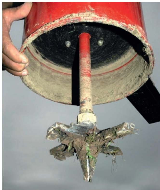
Abb. 6: Das Zerkleinern der Wurzeln mit einem solchen Fräsorgan führte zu unbefriedigenden Ergebnissen.
