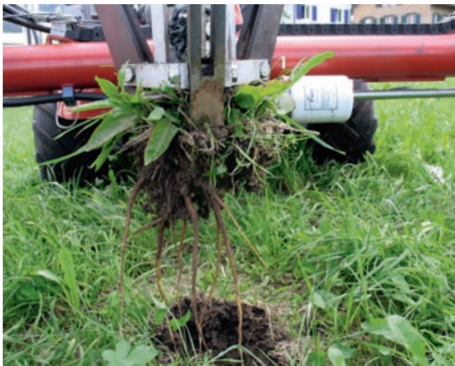
Abb. 4: Der Wurzelausreisser «Wuzi» hat einen hohen Bekämpfungserfolg, hinterlässt aber grosse Löcher in der Wiese.
