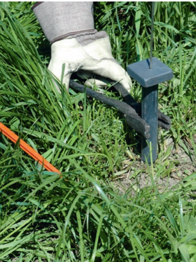
Abb. 7: Eigene Untersuchungen mit 800 °C heißen «Erdnägeln» lieferten schlechte Resultate.
