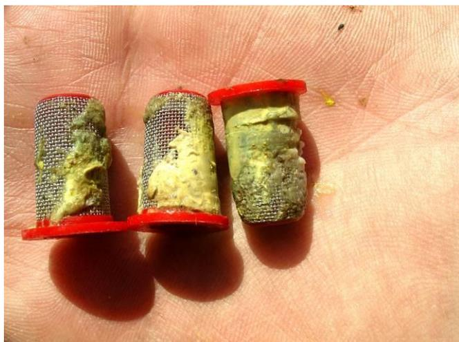
**Foto 2:** miscele inappropriate possono causare precipitazione e formazione di un deposito che provoca l'occlusione degli ugelli (foto J. Rüegg).
