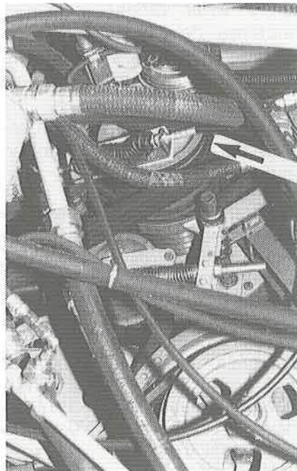
Fig. 18: Entraînements principaux, flèche = arbre de sortie du moteur.
