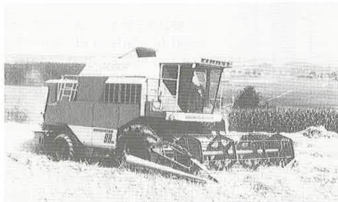
*Fig. 9: Fonctionnement sans perturbations de la plate-forme de coupe en seigle sec, entièrement versé.*
