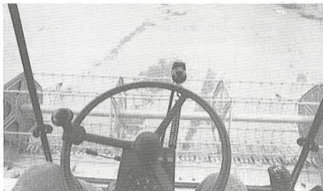
Fig. 15: Conditions de visibilité sur la plate-forme de coupe depuis le poste de conduite.
