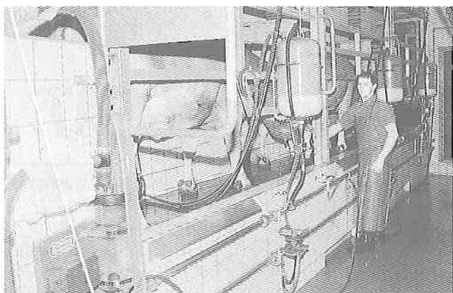
Fig. 2: Traite dans une salle de traite à tunnel 1 x 3.
