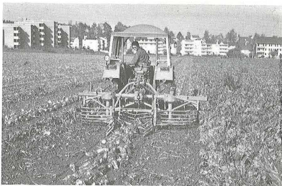
Fig. 4b: Système à trois phases: arracheuse.
