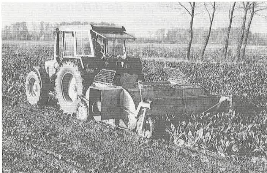
Fig. 2a: Système à deux phases: décolleteuse-arracheuse, poussée par un tracteur qui roule en marche arrière.
