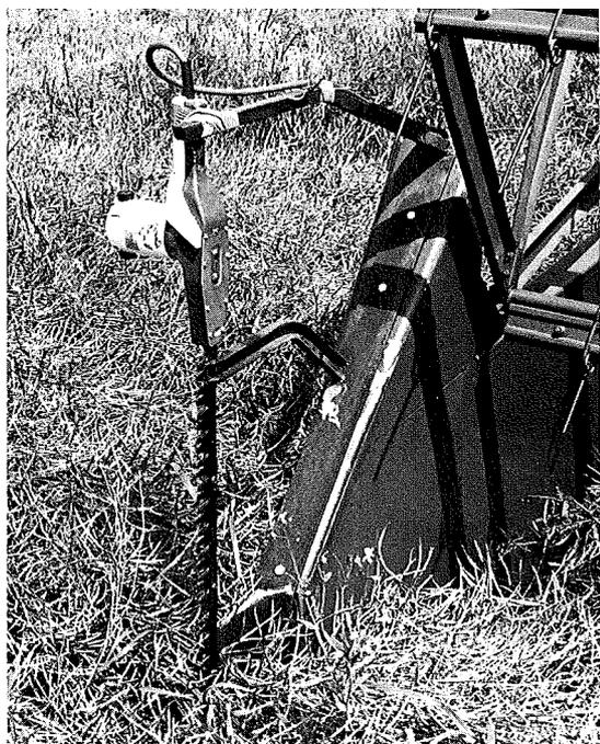
Fig. 2: Dispositif de fauche latéral (ciseaux à colza) à commande électrique, monté sur le flanc droit du dispositif de coupe. Les exécutions à commande mécanique ou hydraulique, plus chères, sont également moins sujettes à usure et donc plus avantageuses au niveau d'utilisations chaque année très larges.
