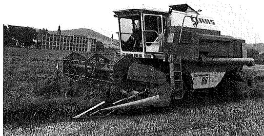
Fig. 9: Intervention de la machine à l'encontre des tiges de colza versé. C'est dans cette direction de travail que les pertes de grains au niveau des deux dispositifs de coupe ont été les moindres.
