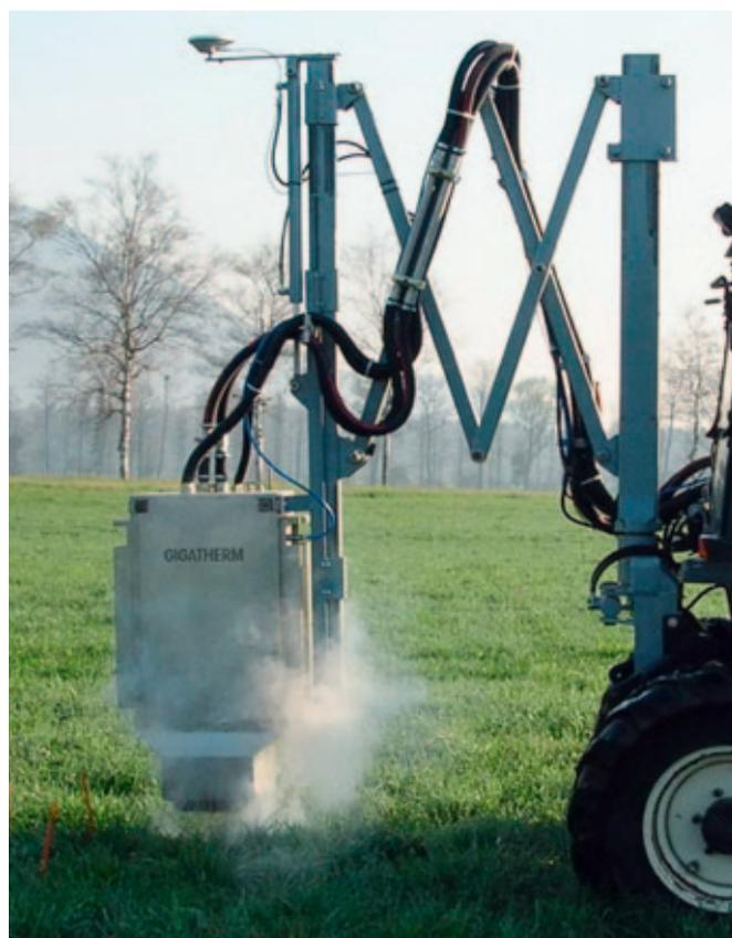
Fig. 8: La lutte contre les rumex avec des micro-ondes est certes efficace, mais n'est pas rentable sur le plan économique.
