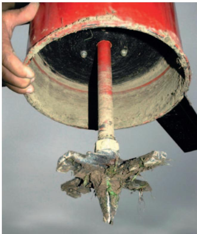
Fig. 6: Le broyage des racines à l'aide d'une fraise de ce type n'a pas donné de résultats satisfaisants.
