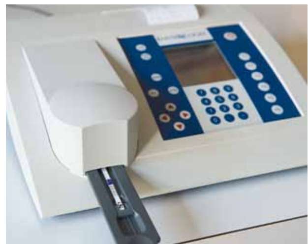
Figure 3 | Le lecteur de QuickStix™ permet d'obtenir des résultats semi-quantitatifs.
