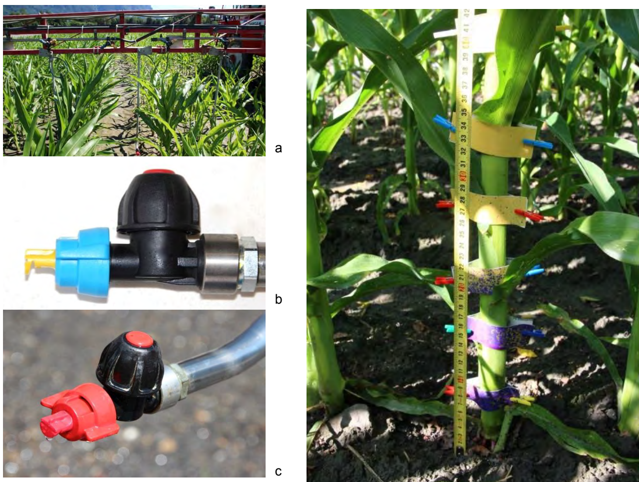
Fig. 24: Mise en œuvre de droplegs dans une culture de maïs à un stade avancé de développement (a). Seules les parties les plus basses des tiges sont aspergées; le feuillage reste presque totalement hors d'atteinte de l'aspersion (à droite sur la photo). Le dropleg est équipé d'une buse à languette dirigée vers le bas contre le sol, avec un angle d'aspersion de 140° (b, c). La largeur de la bande d'aspersion est réglée par la hauteur de la buse (hauteur de la barre de traitement) au-dessus du sol.
