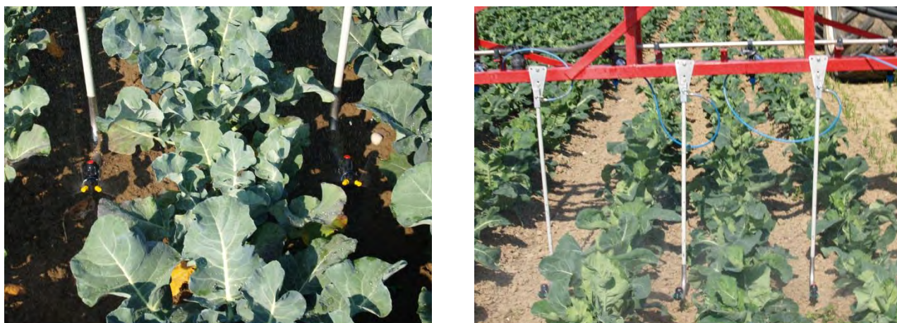
Fig. 13: Dropleg équipé de deux paires de buses à languette, en utilisation combinée avec des buses d'injection fixées sur la barre au-dessus de la végétation, pour utilisation dans les cultures de brocolis et de choux-fleurs.
