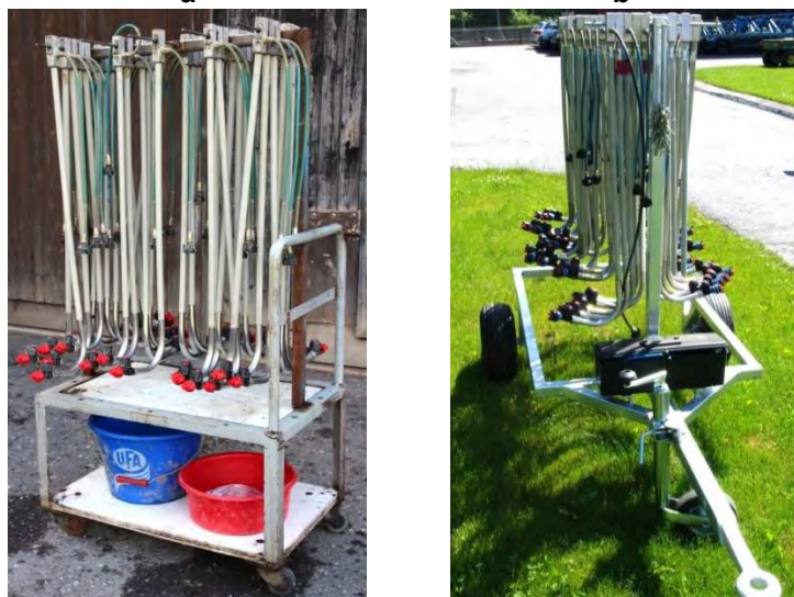
Fig. 28: Exemples de dispositifs de suspension fabriqués sur place pour l'entreposage simple, rapide et mobile des droplegs.
