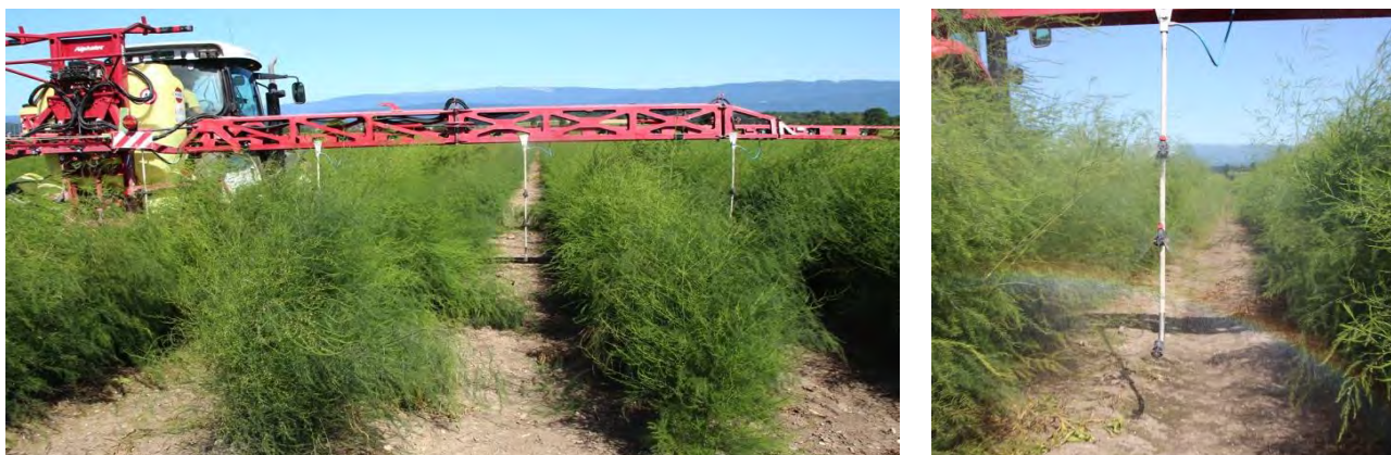
Fig. 22: Droplegs en utilisation expérimentale dans une culture d'asperges le 18 juillet 2012: longueur du tube 120 cm, avec trois paires de buses à languette de calibre 05; interligne 1.8 m, volume de bouillie 1000 l/ha, pression 5 bars, vitesse d'avancement 5 km/h.
