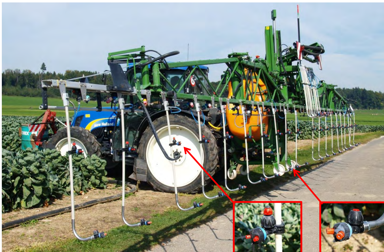
Fig. 1: Modèle allongé de droplegs. Chaque pendillard est pourvu de deux paires de buses à languette sur deux hauteurs pour l'application de fongicides et d'insecticides sur choux de Bruxelles. Les buses situées plus haut sur la rampe sont mises hors service.
