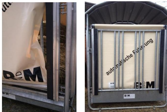
Fig. 6: Problèmes de fonctionnement du dispositif de fermeture/ouverture
