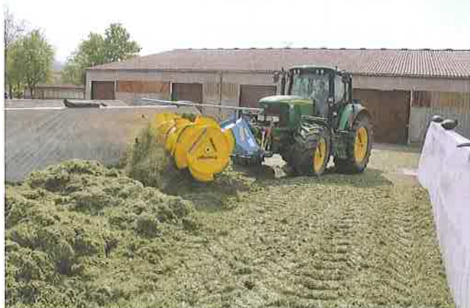
Siloverteiler ermöglichen die gleichmässige Verteilung des Futters, was eine wichtige Grundvoraussetzung für eine gute Futterqualität ist.
