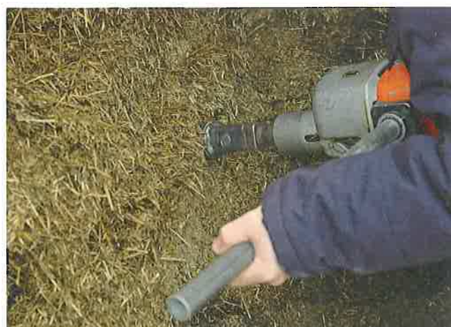
Die Bestimmung der Lagerungsdichten mittels Bohrkernproben zeigte, dass in den Silos die Dichten sehr heterogen sind.
