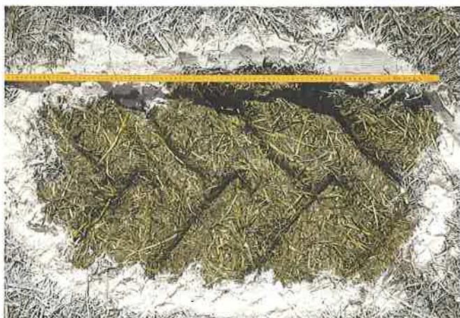
Die Aufstandsfläche der Räder wurde im Silo durch Markieren mit Kalk und anschliessender photogrammetrischer Flächenbestimmung erhoben.
