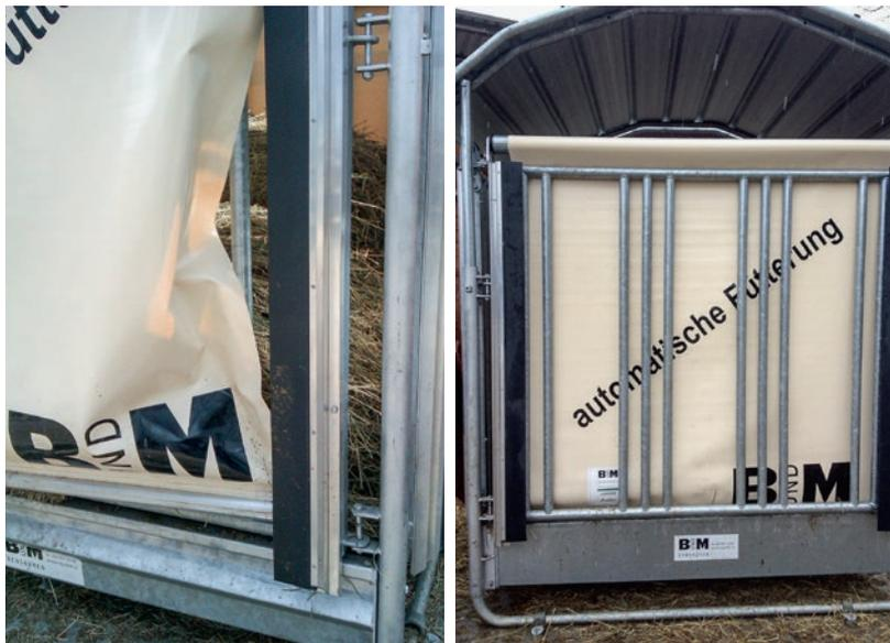
Abb. 3 | Funktionalitätsstörungen des Schliessvorgangs. (Foto: Agroscope)
