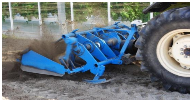
Abb. 1: Zerstörung der Struktur der obersten Bodenschicht durch eine Spatmaschine.
