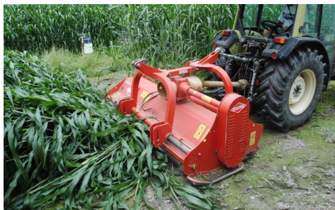
Abb. 5: Sorghum-Sudangras wird vom Mulchgerät niedergedrückt, deswegen werden die Stengel nicht erfasst und zerkleinert.
