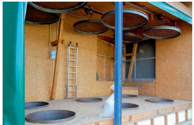
Fig. 9: Dispositif à deux rangées avec canal souterrain à base de bois. En haut, on aperçoit les couvercles des balles, en bas, l'isolation thermique du canal souterrain.
