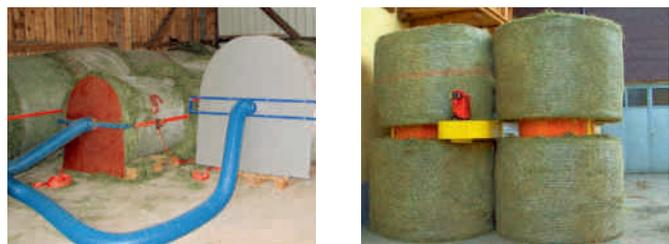
Fig. 11: À gauche, séchage avec conduite centrale; à droite, installation compacte avec quatre anneaux intermédiaires.
