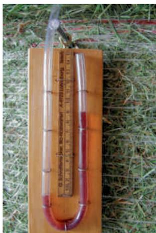
Fig. 20: Mesure de la pression avec un tube en PVC. Une extrémité du tube passe dans le canal de la balle, la différence de niveau d'eau indique la pression en mm de colonne d'eau (1 mm de colonne d'eau = env. 10 Pa).
