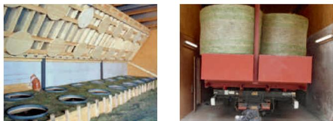
Fig. 13: À gauche, dispositif sur deux rangées avec canal en bois et partie supérieure articulée pouvant être utilisée pour le séchage, alimenté avec du bois déchiqueté; à droite, séchage sur remorque.
