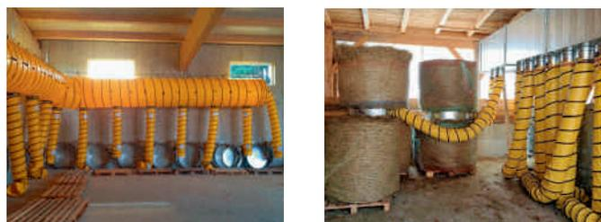
Fig. 12: À gauche, ventilation avec tuyaux souples et cercles intermédiaires; à droite, canal en tôle combiné avec des tuyaux souples.
