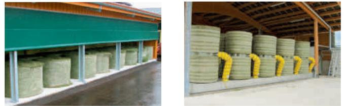
Fig. 8: À gauche, installation sur deux rangées avec canal en béton et bâche coulissante sur la façade extérieure du bâtiment; à droite, installation avec canal en tôle fixe et anneaux intermédiaires de répartition d'air.
