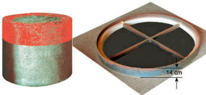
Fig. 14: À gauche, zone problématique en cas de ventilation par le bas (en rouge); à droite, emplacement pour balle avec croisillon et cerclage de tôle.
