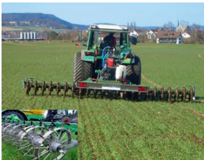
Figure 4.5: Utilisation de l'appareil d'injection CULTAN de la firme Peter Briner AG dans des essais de blé d'automne d'Agroscope (Reckenholz-Tänikon).
