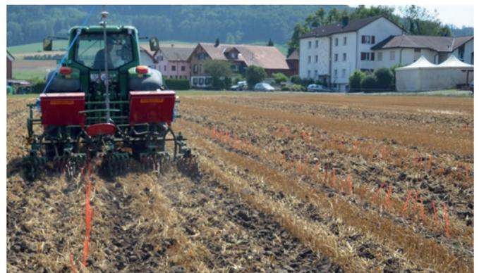
Fig. 6: Avec les 25 cm prévus par la machine entre les outils de sarclage, les piquets de marquage sont tous restés debout, aucun n'a été arraché. (Photos: Martin Dimitri, EPF Zurich)
