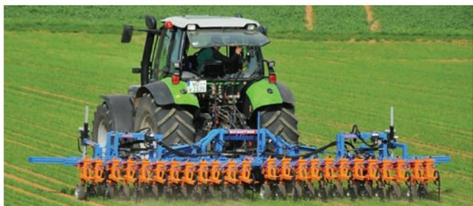
Fig. 2: Sarcleurs pilotés par des caméras individuelles pour le sarclage dans plusieurs écartements de semis. (Photo: Schmotzer)
