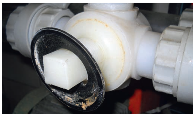
Figure 13: Des points faibles en matière d'hygiène découverts lors de visites d'étables. L'image de gauche montre une griffe avec du lait caillé à l'intérieur. À droite, un robinet à trois voies avec des résidus de lait.
