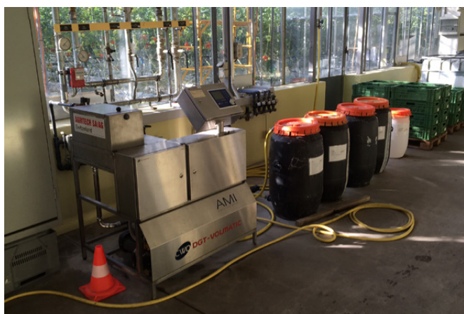
Figure 4. Ordinateur pour mélanger et gérer la fertigation pour les cultures maraîchères sous serre (photo: Agroscope).
