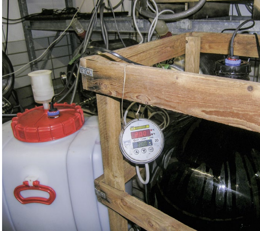
Abb. 5: Die Versuche erfolgten entweder oxidativ im 65-L-Polyethylentank oder unter reduktiven Bedingungen im Glasballon jeweils bei konstanter Temperatur.
