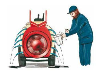
Débit des buses =  $\frac{\text{vitesse (km/h) x distance interligne (m) x volume (l/ha)}}{600 \text{ x nombre de buses ouvertes}}$
