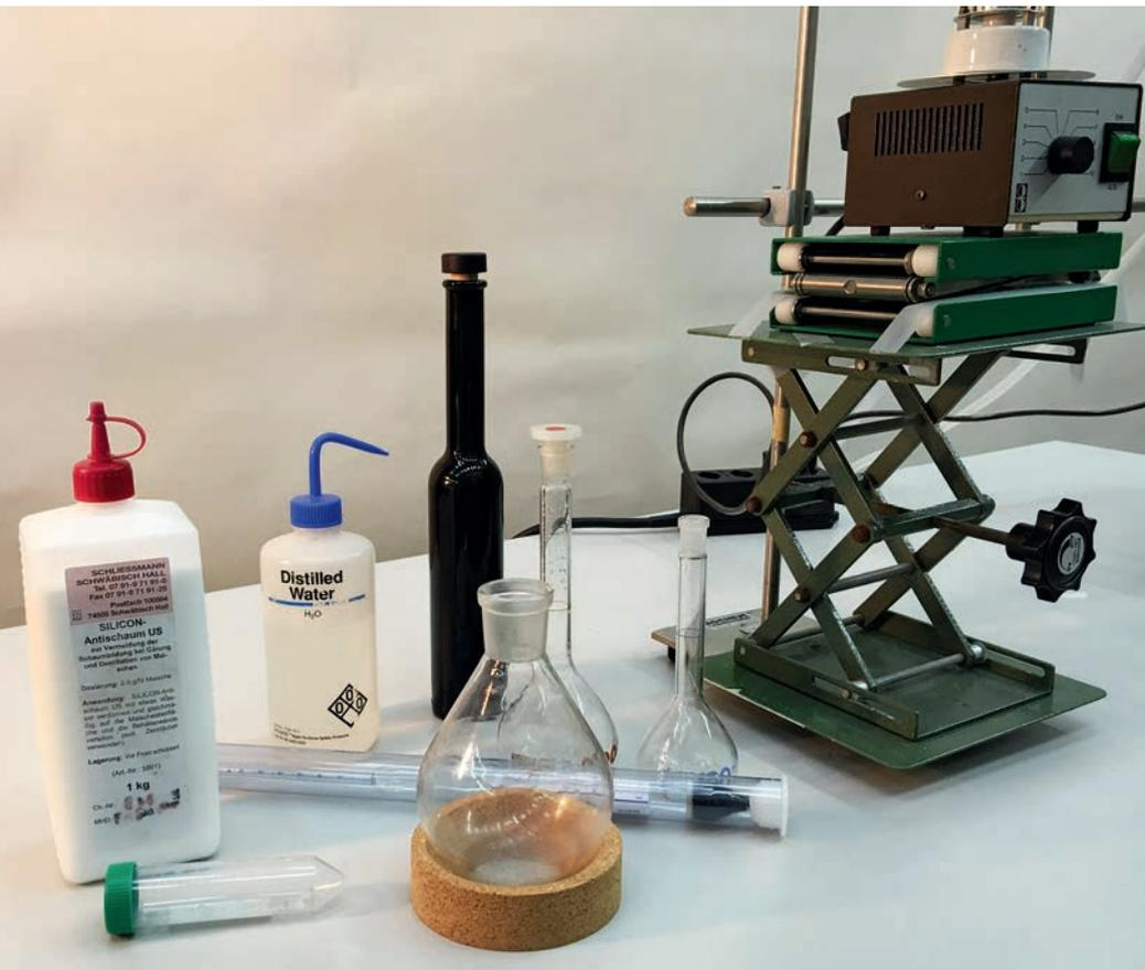
Messkolben mit 100 ml und 200 ml Füllvolumen, Destillierkolben und weitere Materialien, die zur destillativen Alkoholbestimmung notwendig sind.
