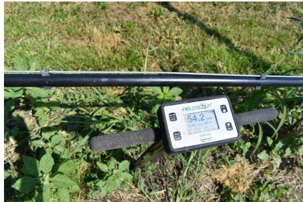
Abbildung 4: Messung des Bodenwassergehalts mit dem mobilen Messgerät TDR350. Da die Bäume bewässert werden, war trotz des trockenen Jahres während der ganzen Saison genügend Wasser vorhanden (in diesem Beispiel 52.4%).
