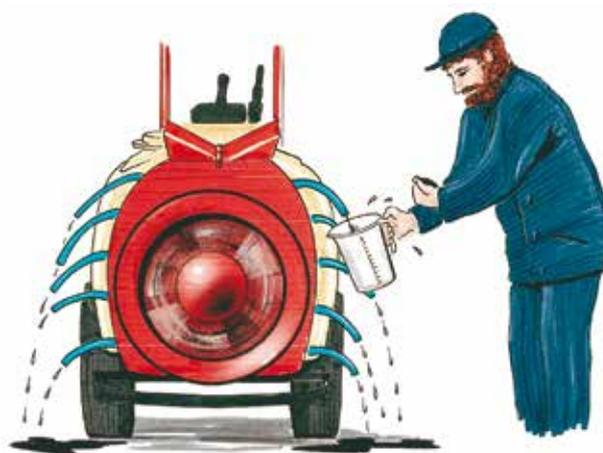
$$\text{Débit des buses} = \frac{\text{vitesse (km/h)} \times \text{distance interligne (m)} \times \text{volume (l/ha)}}{600 \times \text{nombre de buses ouvertes}}$$
