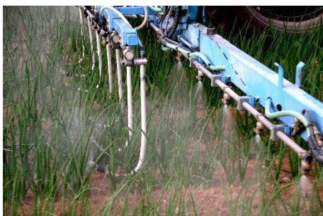
Foto 13: impiego combinato di Droplegs e barra di trattamento su cipolle (foto: J. Rüegg, Agroscope).
