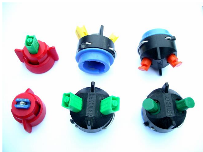
Abb. 2: Einfachdüsenhalterung mit konventioneller Flachstrahldüse (unten links) oder Air-Injektorkompaktdüse (oben links). Doppeldüsenhalterung (Twin Spray Cap) mit Air-Injektor-Kompaktdüsen (Mitte) oder Flachstrahldefflektordüsen (rechts). Beide Halterungen können mittels der gängigen Bajonettverschlüsse rasch an den Spritzgeräten montiert werden.
