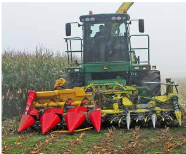
Figure 1 | Powermaïs avec une ensileuse automotrice équipée pour la récolte de trois rangs en plantes entières et trois rangs d'épis. (Photo: Ueli Wyss, Agroscope)
