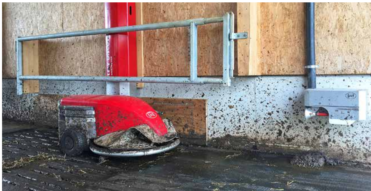
Abb. 1 | Ladestation mit Roboter (links) und Wasserfüllstation (rechts) des Entmistungsroboters.
