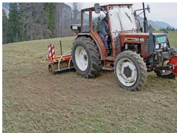
Le rouleau-semoir permet d'effectuer des sursemis efficaces et pas coûteux.
