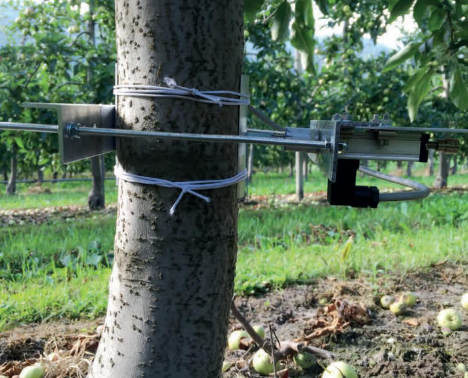
▲ Abbildung 4: Dendrometer zur Messung der Baumstämme. Die Abbildung 3 veranschaulicht die mit diesem Gerät beobachteten Wachstumsschwankungen.
