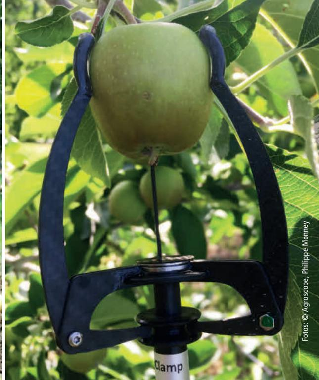
▲ Abbildung 5: Messung des Obstwachstums mit dem neuen Sensor, der von JDC Electronic SA in Yverdon entwickelt wurde.
