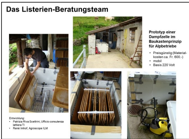
Abb. 4: Dampfzelle im Baukastenprinzip für Alpen und Kleinstbetriebe
