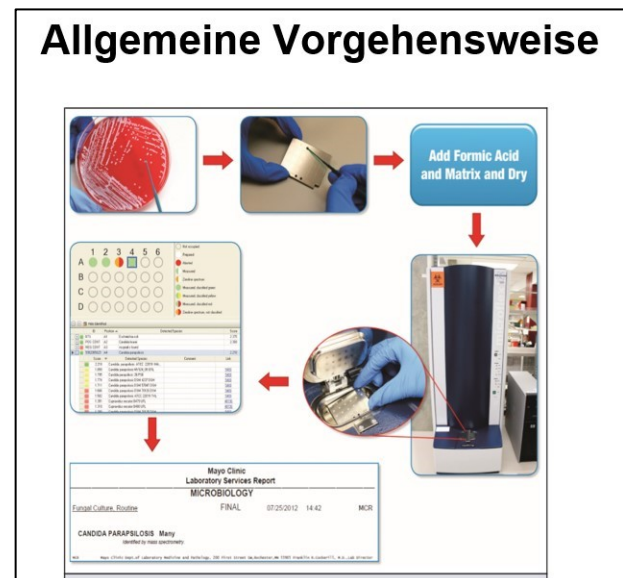
Abb. 20: Vorgehen bei der MALDI-TOF-Analyse
