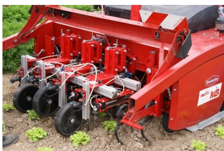
Foto 1: nell'ambito del progetto «Resourcenschonender, nachhaltiger Pflanzenschutz» in orticoltura con l'uso del robot per i trattamenti fitosanitari comandato mediante telecamera è stata abbinata una sarchiatrice Steketee alla tecnica Spot Spraying (foto: Agroscope).
