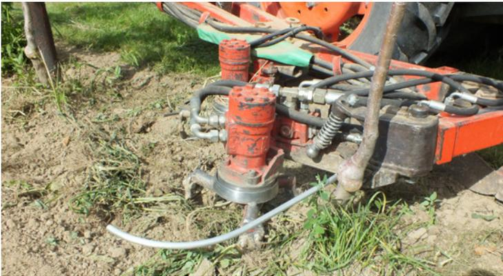
**Abb. 8: Krümpler mit hydraulischer Stammauslenkung**
