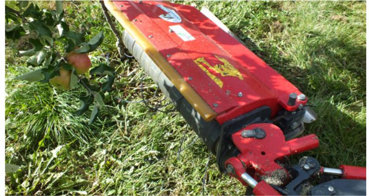
**Abb. 9: Fadengerät mit mechanischer Stammauslenkung**
