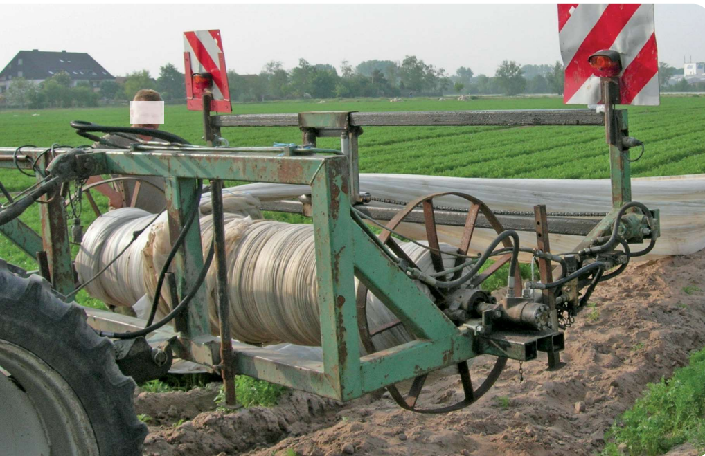
Aufrollen des Kulturschutznetzes mit Wickelvorrichtung am Traktor.
