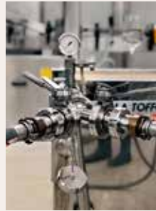
Schichtenfilter vor dem Füllen. (© WBZW)
