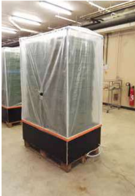
Automatisierte Versuchseinheit für die Lagerung von 200 kg Kartoffeln.
