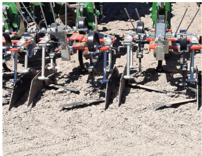
Abb.1: Flache Winkelmesser mit Kulturschutzblechen eignen sich für stark verschlammte Böden nur bedingt, da die Messer sehr grosse «Platten» anheben und dabei auch kleine Kulturpflanzen entwurzeln (Foto: R. Total, Agroscope).
