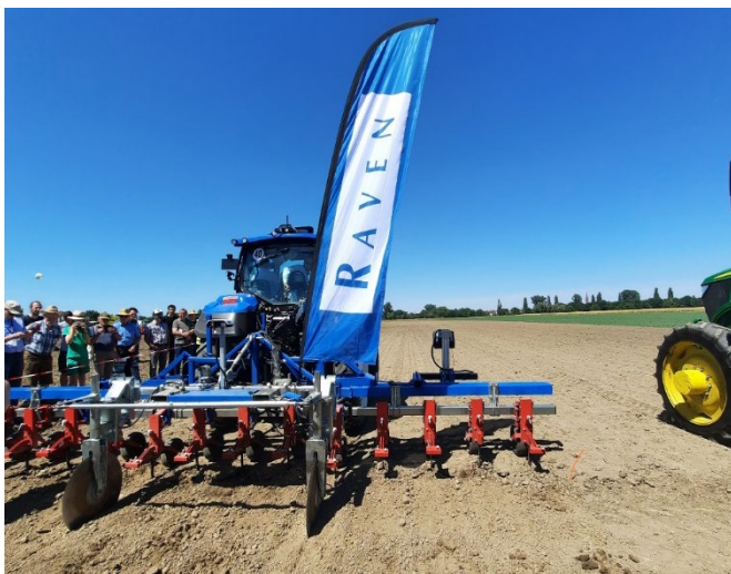
Abb. 2: Kameralensystem zur automatischen, präzisen Reihenführung der Hackgeräte von Raven (Foto: R. Total, Agroscope).
