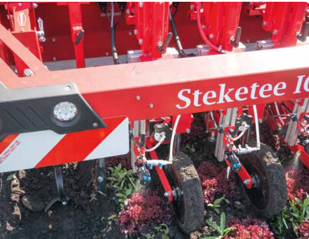
Der Steketee IC Weeder wurde zusätzlich mit einem kleinen Tank und Düsen ausgestattet, die sensoren- und kameragesteuert präzise Insektizide oder Fungizide versprühen. DAVID EPPENBERGER
