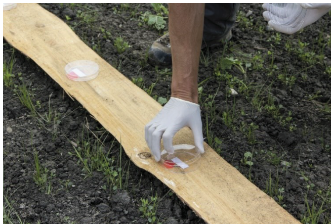
Immagine 2: dopo il trattamento si raccolgono i collettori. L'analisi viene eseguita in laboratorio (foto: Agroscope).
