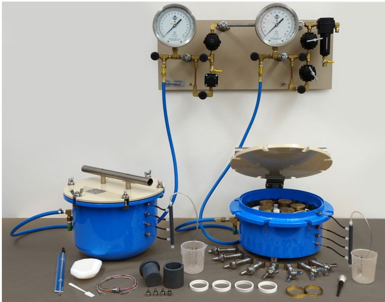
Abbildung 12: Handelsübliche Drucktopfanlage als Überdruckapparatur zur Ermittlung des Porenvolumens in höheren pF-Bereichen, d.h. für die Mittel- und Feinporen. Bildquelle: Freundliche Genehmigung der UGT GmbH.
