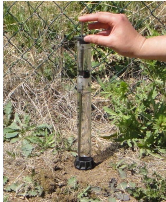
Abbildung 24: Das Mini-Disk-Infiltrometer zur Bestimmung der Infiltrationsrate ist ein handliches Tensionsinfiltrometer, welches nur von einer Person bedient werden kann.
