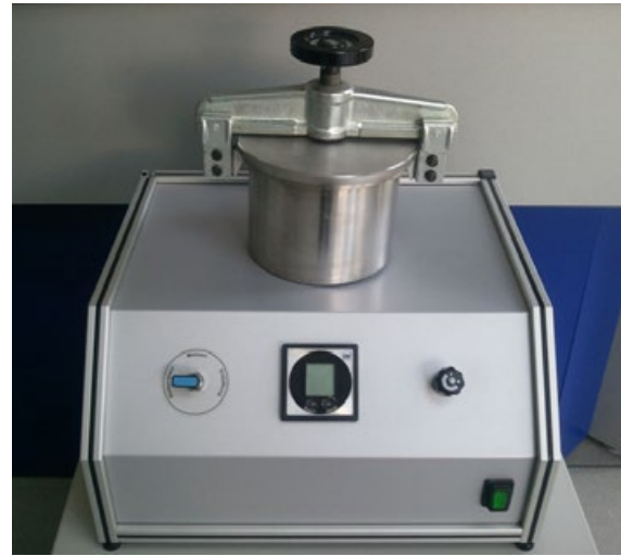
Abbildung 8: Luftpyknometer zur Bestimmung der Festsubstanz einer Bodenprobe. Es sind strukturell ungestörte Proben notwendig. Bildquelle: Freundliche Genehmigung von UGT GmbH.
