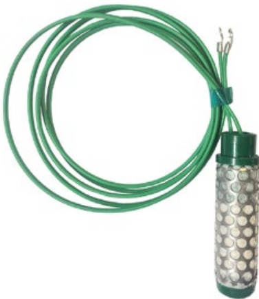
Abbildung 29: Handelsüblicher Watermark-Sensor bestehend aus zwei Elektroden, die in das gipsgetränkte Gewebe eingearbeitet sind, welches von einer perforierten Hülle eingefasst wird.
