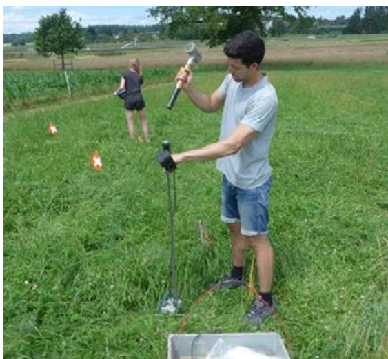
Abbildung 35: Die Panda-Sonde ist ein Beispiel für ein dynamisches Penetrometer zur Ermittlung des Eindringwiderstandes in den Boden.
