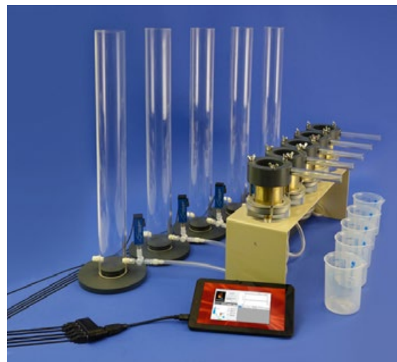
Abbildung 20: Apparatur zur simultanen Messung der gesättigten hydraulischen Leitfähigkeit an fünf Zylindern mit strukturell ungestörten Bodenproben. An der gleichen Apparatur kann sowohl die Methode «fallende Druckhöhe» wie «konstante Druckhöhe» (durch Anbringen eines Aufsatzes auf die Kunststoffzylinder) verwendet werden.
