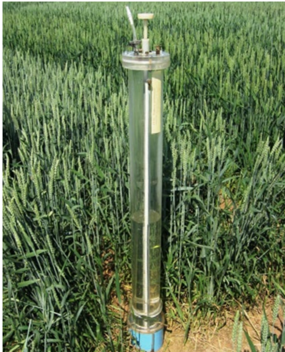
Abbildung 23: Grosses Tensions-Infiltrometer zur Ermittlung der Wasserinfiltration in einen Boden auf einem Ackerstandort. Oben links an der Apparatur ist das Unterdruckrohr zu sehen, welches einen Luffeinlass hat und mit dem Wasserreservoir verbunden ist.
