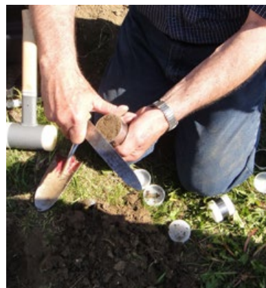
Abbildung 4: Eine Zylinderprobe, die mit einem Messer exakt auf das Normvolumen präpariert wurde. Bildquelle: Freundliche Genehmigung von Báfková, K., Matula, S. und Miháliková, M., Faculty of Agrobiology, Food and Natural Resources Czech University of Life Sciences Prague.
