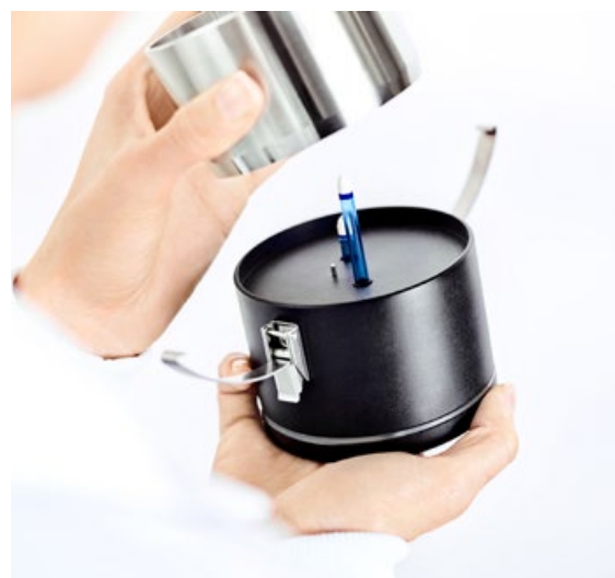
Abbildung 14: Hyprop 2 für die Messung des Porenvolumens im Saugspannungsbereich von 0-820 hPa (ganzer Grobporenbereich bis grobe Mittelporen). Der Hyprop 2 erlaubt an strukturell ungestörten Bodenproben die simultane Messung der Desorptionskurve im angegebenen Saugspannungsbereich und der ungesättigten Wasserleitfähigkeit. Bildquellen: Freundliche Genehmigung der METER Group.
