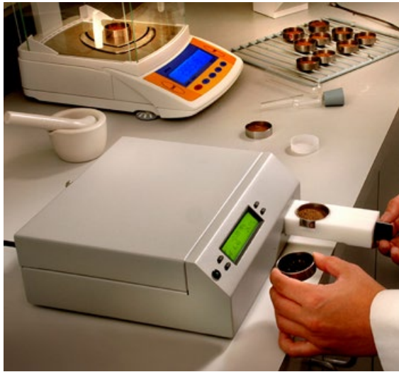
Abbildung 15: Das WP4C-Dew Point Meter erlaubt die Bestimmung der Feinporen im Messbereich pF 3.5 – 6.2. Dafür sind keine strukturell ungestörten Proben notwendig. Bildquelle: Freundliche Genehmigung der METER Group.
