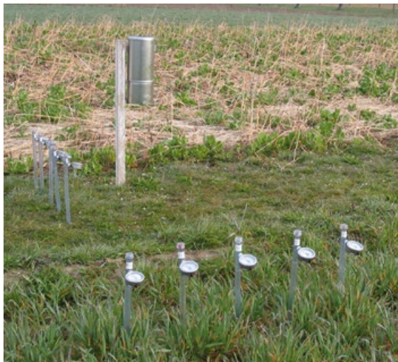
Abbildung 27: Dauerhaft im Feld installierte Tensiometer beim Langzeitversuch Oberacker im Kanton Bern zur Messung der Saugspannung. Bildquelle: Freundliche Genehmigung von Lorenz Ramseier, LANAT, Fachstelle Bodenschutz Kt. Bern.
