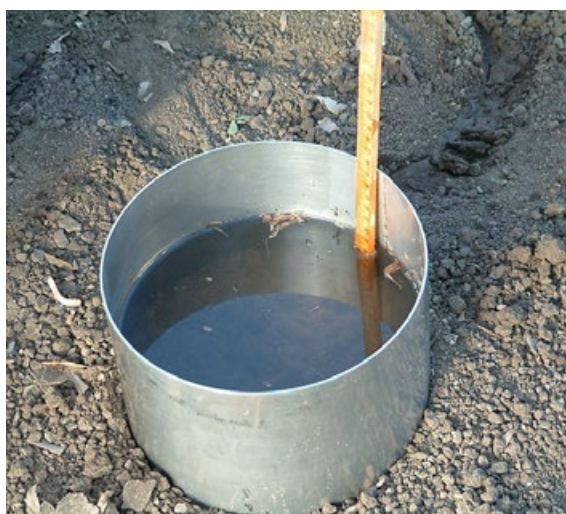
Abbildung 21: Einzelring-Infiltrometer im Einsatz zur Bestimmung der Infiltrationsrate in den Boden. Bildquelle: Wikimedia Commons.
