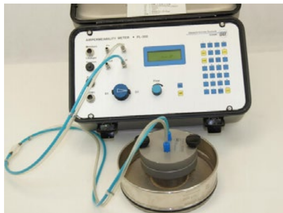
Abbildung 17: Flowmeter PL-300 zur Bestimmung der Luftleitfähigkeitsbedingungen in einer strukturell ungestörten Bodenprobe. Bildquelle: Freundliche Genehmigung der UGT GmbH.
