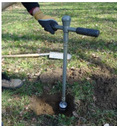
Abbildung 2: Einbringen der Schlagsonde mit einem enthaltenen Stechzylinder in den Boden zur Entnahme einer ungestörten Bodenprobe. Bildquelle: Freundliche Genehmigung der Forschungsgruppe Bodennutzung und Bodenschutz der HAFL.
