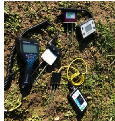
Abbildung 32: Auswahl an verschiedenen Modellen von TDR-Sonden zur Messung des volumetrischen Wassergehaltes. Bildquelle: KOBO.
