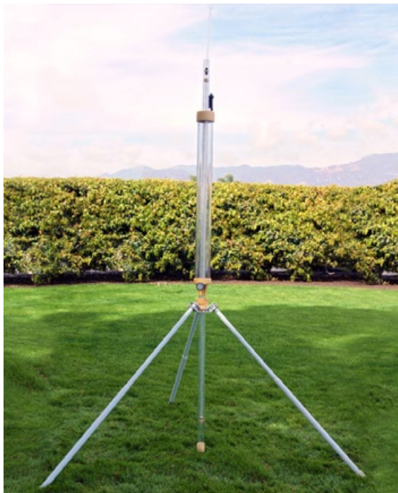
Abbildung 25: Handelsübliches Guelph-Permeameter zur Messung der Infiltrationsrate in den Boden. Bildquelle: Freundliche Genehmigung von SoilMoisture Corp.
