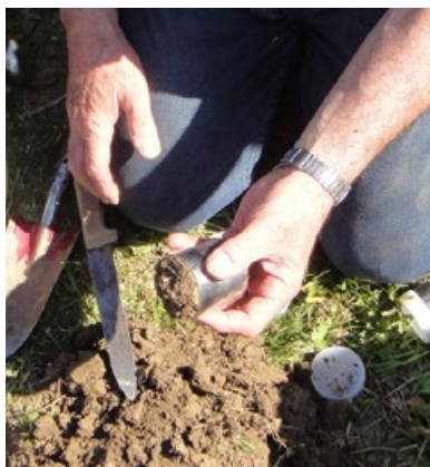
Abbildung 3: Ungestörte Zylinderprobe, welche noch auf das definierte Normvolumen präpariert werden muss. Bildquelle: Freundliche Genehmigung von Báfková, K., Matula, S. und Miháliková, M., Faculty of Agrobiology, Food and Natural Resources Czech University of Life Sciences Prague.
