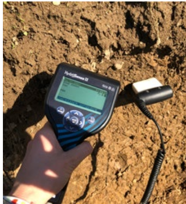
Abbildung 31: Einsatz einer TDR-Sonde auf der Bodenoberfläche zur Messung des volumetrischen Wassergehaltes. Bildquelle: KOBO.
