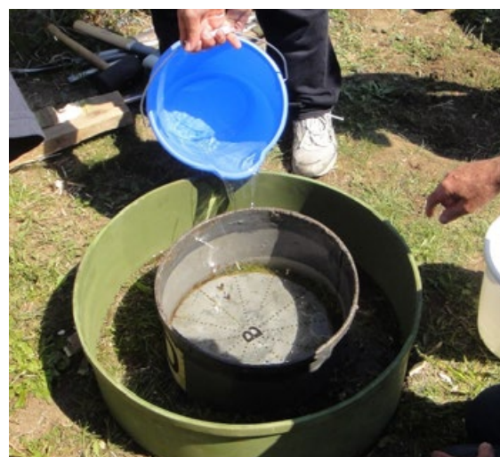
Abbildung 22: Doppelringinfiltrometer im Einsatz zur Bestimmung der Infiltrationsrate. Bildquelle: Freundliche Genehmigung von Bářková, K., Matula, S. und Miháliková, M., Faculty of Agrobiology, Food and Natural Resources, Czech University of Life Sciences Prague.
