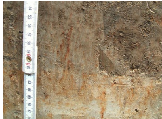
Abbildung 34: Profilwand mit Rostflecken, deutliche Zeichen von Redoxreaktionen, welche stattgefunden haben.
