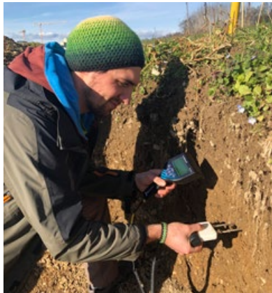
Abbildung 30: Einsatz einer TDR-Sonde an der Profilwand zur Messung des volumetrischen Wassergehaltes. Bildquelle: KOBO.
