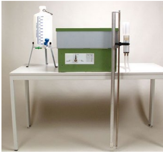
Abbildung 10: Handelsübliche Sandbox als Unterdruckapparat zur Ermittlung des Grobporenvolumens einer Bodenprobe. Bildquelle: Freundliche Genehmigung von Royal Eijkelkamp.
