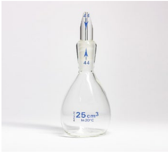
Abbildung 7: Handelsübliches Wasser-Pyknometer zur Bestimmung der Dichte von Festkörpern. Hierfür sind keine strukturell ungestörten Bodenproben notwendig. Bildquelle: Wikimedia Commons.
