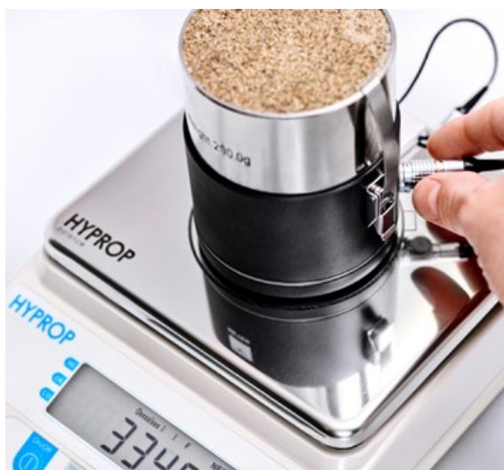
Abbildung 14: Hyprop 2 für die Messung des Porenvolumens im Saugspannungsbereich von 0-820 hPa (ganzer Grobporenbereich bis grobe Mittelporen). Der Hyprop 2 erlaubt an strukturell ungestörten Bodenproben die simultane Messung der Desorptionskurve im angegebenen Saugspannungsbereich und der ungesättigten Wasserleitfähigkeit. Bildquellen: Freundliche Genehmigung der METER Group.
