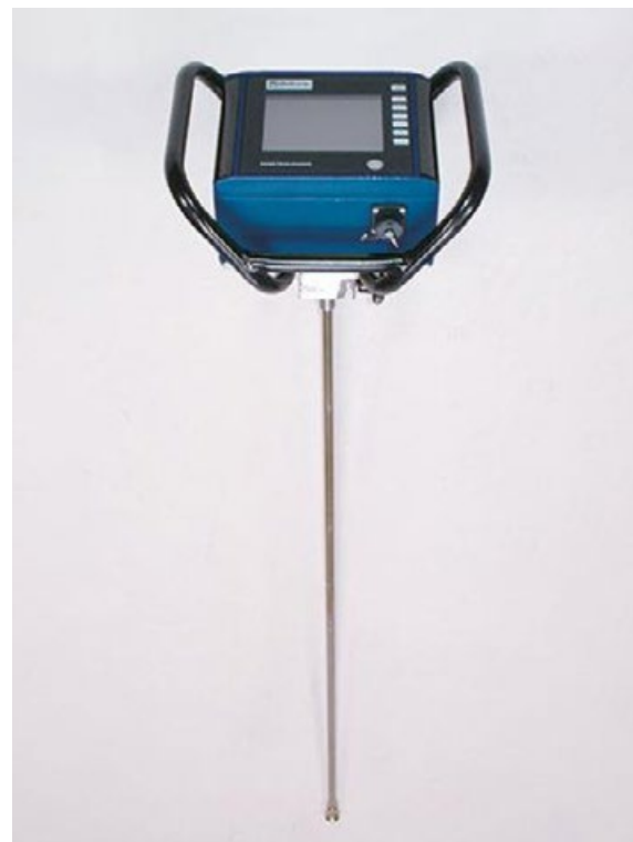
Abbildung 36: Auf dem Markt erhältliches statisches Penetrometer zur Ermittlung des Eindringwiderstandes in den Boden.
