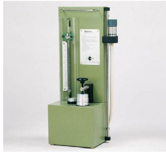
Abbildung 16: Handelsübliches Luftpyknometer welches die Bestimmung des Fest- und Flüssigvolumens einer Bodenprobe erlaubt. Werden getrocknete, strukturell ungestörte Bodenproben verwendet und ist das Gesamtvolumen der Bodenprobe bekannt, so kann das Gesamtporenvolumen berechnet werden. Bildquelle: Freundliche Genehmigung von Royal Eijkamp.
