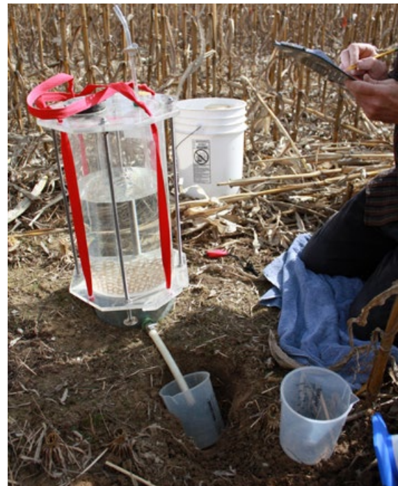
Abbildung 26: Cornell-Sprinkler-Infiltrimeter im Einsatz in einem Maisfeld. Die Infiltrationsrate lässt sich bei dieser Methode als Differenz zwischen der applizierten Regenmenge und der gemessenen Oberflächenabflussrate berechnen. Bildquelle: Freundliche Genehmigung des Cornell Soil Health Staff.
