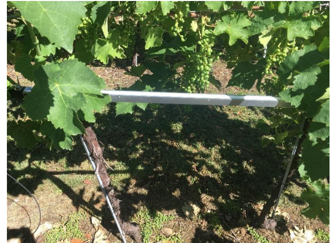
Barre de cellules photoélectriques mesurant l'éclairage ambiant (PAR)
