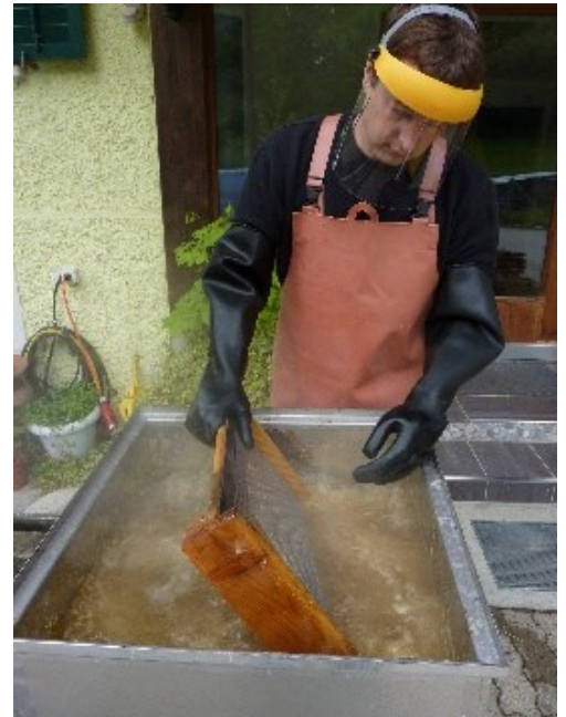
Figura 8: La soda caustica è più pericolosa del carbonato di sodio. Nell'impiegare entrambe le sostanze vanno comunque indossati indumenti di protezione (foto T. Amsler).
