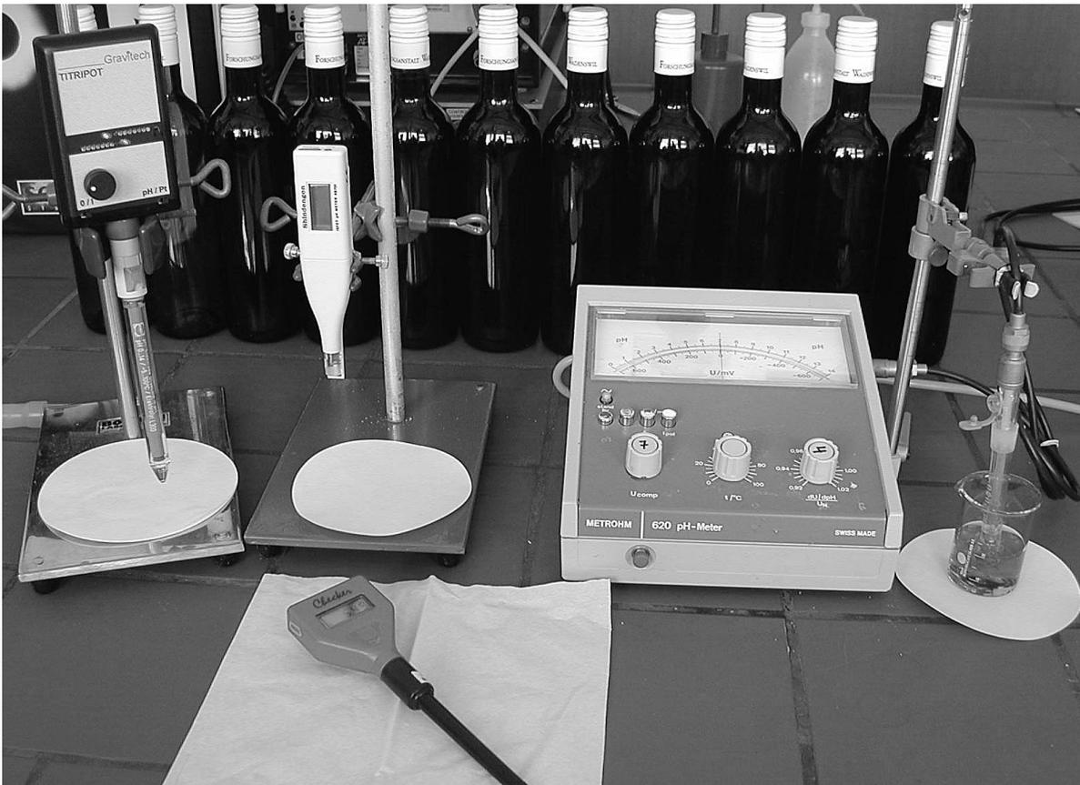
Abb. 2: Die elektronische Anzeige des pH-Wertes lässt auch in stark gefärbten Weinen den Endpunkt exakt erfassen.
