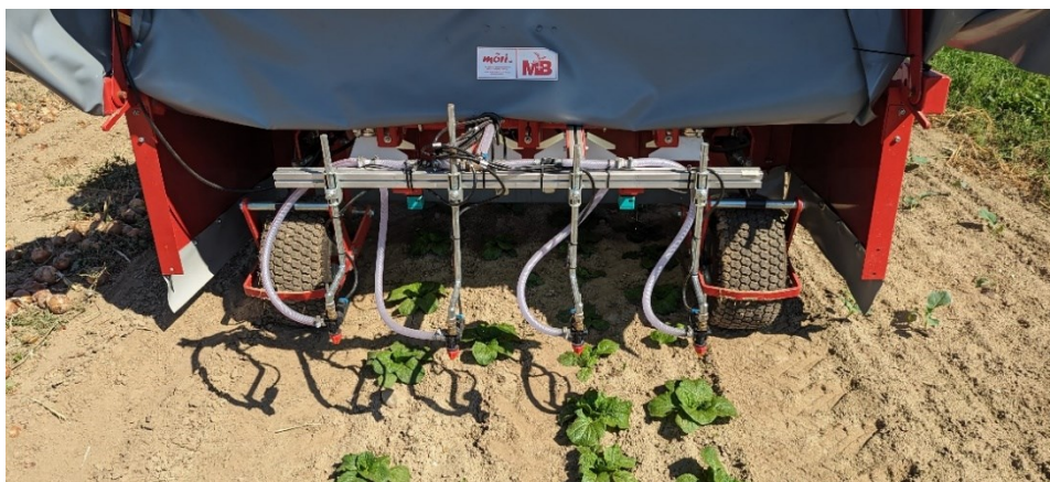
Immagine 1: Gli ugelli vengono condotti sopra le file. Essi si aprono poco prima e poco dopo la pianta coltivata. In questo modo le colture possono essere trattate in modo localizzato e preciso (Foto: Agroscope).
