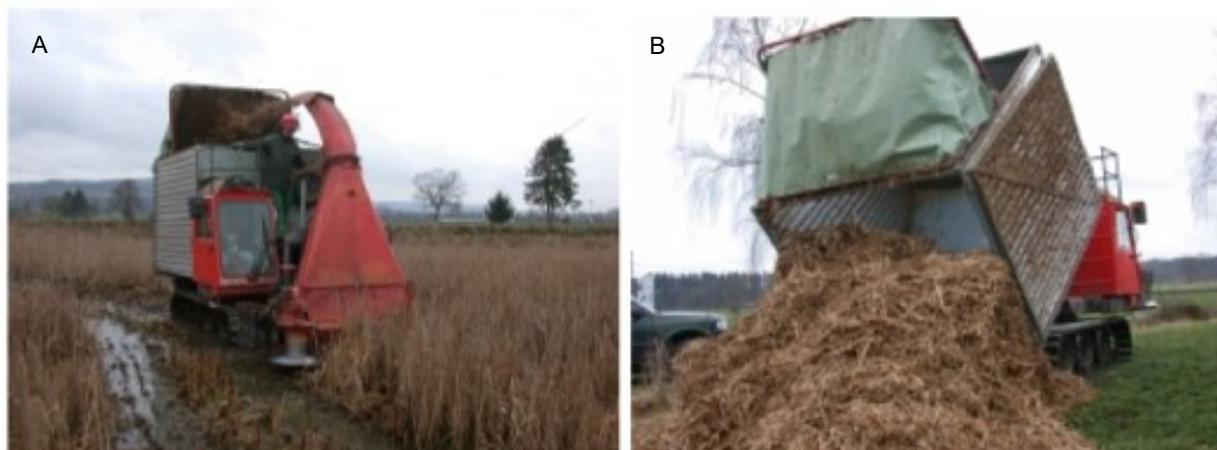
Figure 1: Récolte de massettes au moyen d'une récolteuse à chenilles dans le bassin de rétention de Geuensee (LU) en 2004. A) La machine permet de récolter, broyer et charger les plantes en un seul passage. B) La récolte broyée est ensuite déchargée et transbordée pour le transport ultérieur. Photos: Kulturland 21 GmbH
