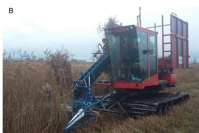
Figure 3: Récolte: A) Compactage de laiches pour la valorisation énergétique au moyen d'une machine agricole spécialement adaptée (09/2019). Photo: F. Birr; B) Fauche des roseaux au moyen d'un engin équipée de chenilles (12/2018), Photo: F. Birr.
