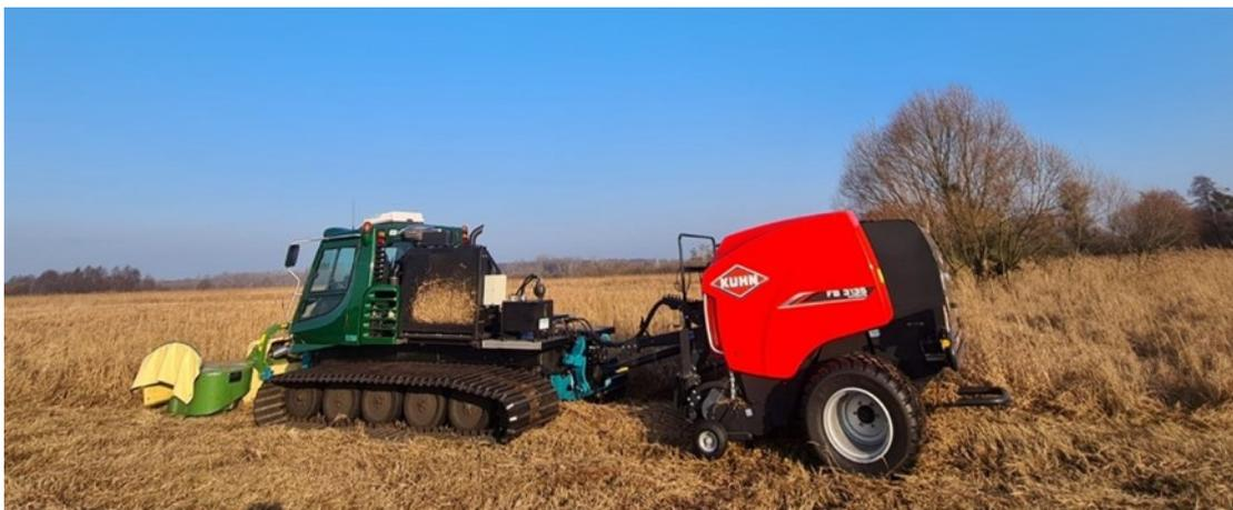
Figure 2: Véhicule tracteur à chenilles (dameuse Pisten-Bully 200 adaptée) et presse à balles rondes à pneus larges. Photo: S. Petri
